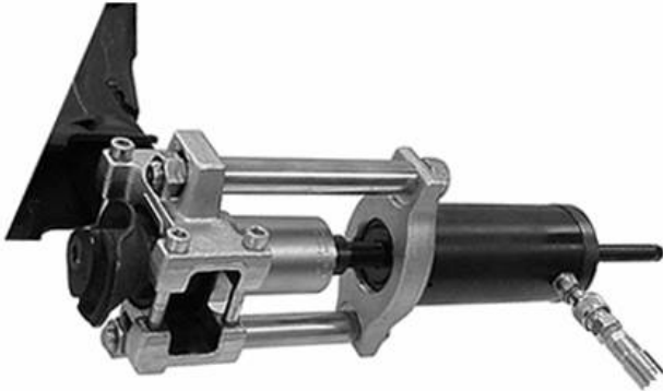
Fig. 5: Press out silent bloc
