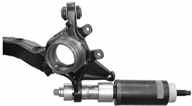
Fig. 6: Insert silent bloc
