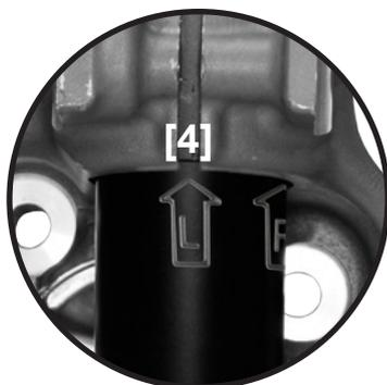
Alojamiento del muñón del eje izquierdo: Montar el amortiguador de forma que la flecha "L" se alinee con la abertura [4].
