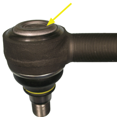
Узел 31 - выпуклая крышка, вдавливание максимум на 2 мм
