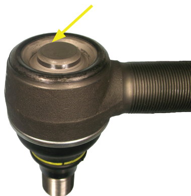
Узел 33 - низко установленная крышка, небольшая конструктивная высота, вдавливание максимум на 0,5 мм
