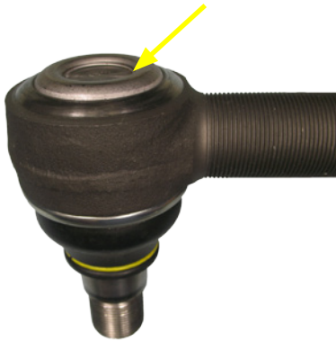
Baugruppe 31 - gewölbte Kappe maximal 2 mm Einfederung
