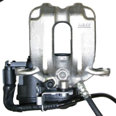
Bremsgehäuse drehen bis der Aktuator (Motor/Getriebeeinheit) nach unten zeigt. Dadurch kann die eingeschlossene Luft aus der Nachstellmutter in den Kolben gelangen.
