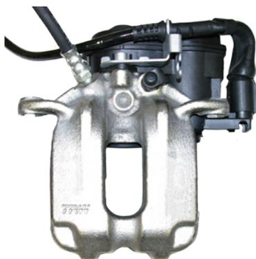
Bremsgehäuse drehen bis der Aktuator nach oben zeigt. Dadurch kann die Luft aus dem Kolben in den Hinterstich der Entlüftungsbohrung gelangen.
