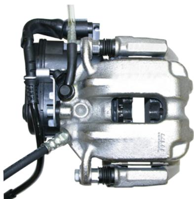
Bremse in Einbaulage mit Entlüftergerät füllen und entlüften (Entlüfternippel oberhalb des Kolbens). Anschließend den Bremsflüssigkeitsdruck komplett abbauen.
