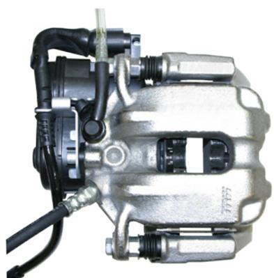
Sattel wieder einbauen, nach Vorschrift befestigen. Bei Bedarf diesen Vorgang mit dem anderen Bremsattel wiederholen. Zum Schluss wie gewohnt mit dem Entlüftergerät die komplette Bremse entlüften.
