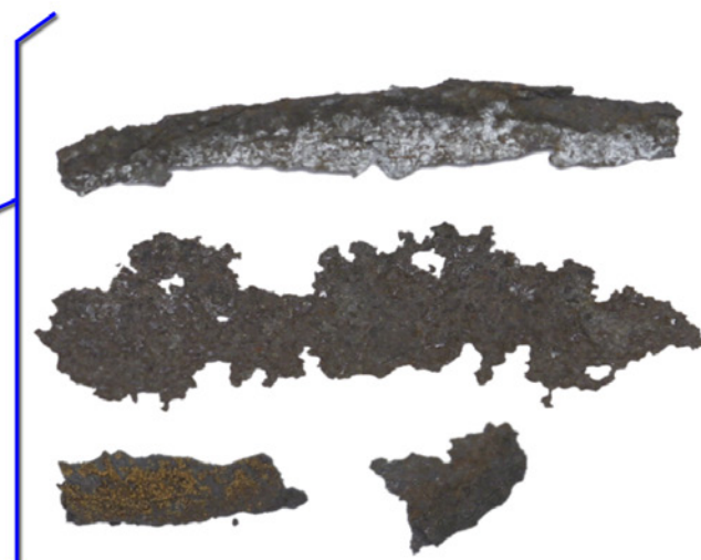
Zvětšené částčky koroze
