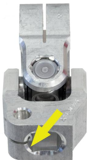
无凹槽的旧接头（转向轴）
