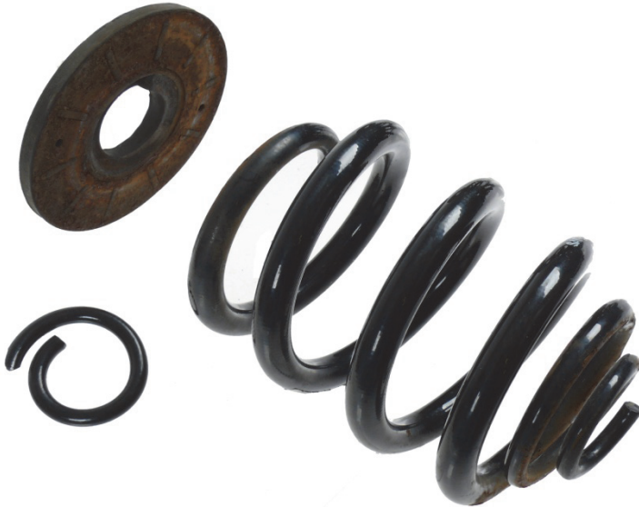
Fig.1: Cajas de muelles desgastadas y muelle de suspensión roto
