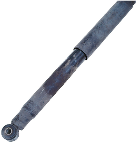
Fig. 1: Brouillard d'huile au niveau de l'amortisseur
