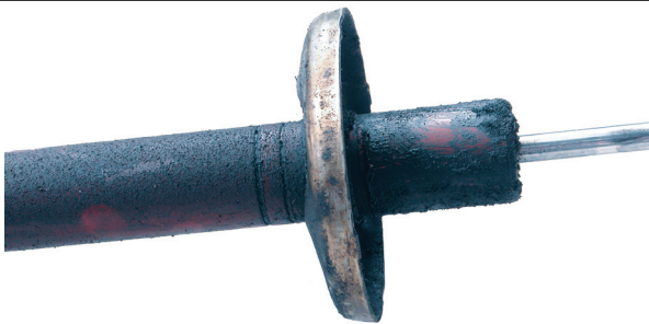
Fig. 1: Brouillard d'huile au niveau de l'amortisseur
