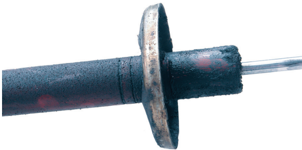
Fig. 2: Selkeitä jälkiä öljystä
