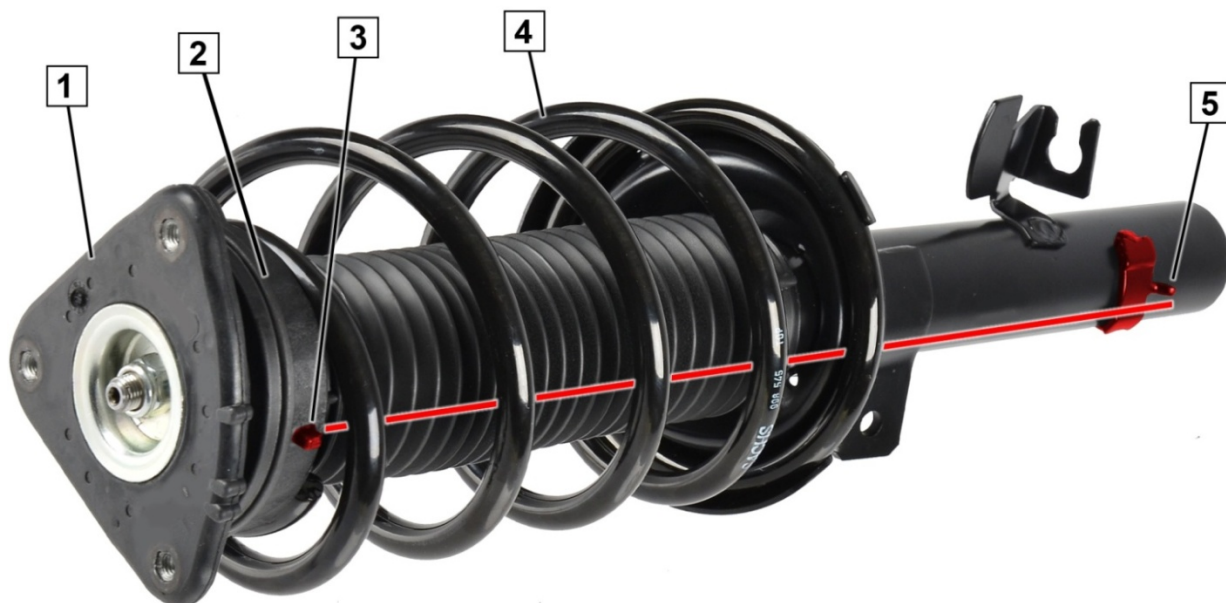
Bild 1: Fjäderbensstödlager korrekt positionerat
