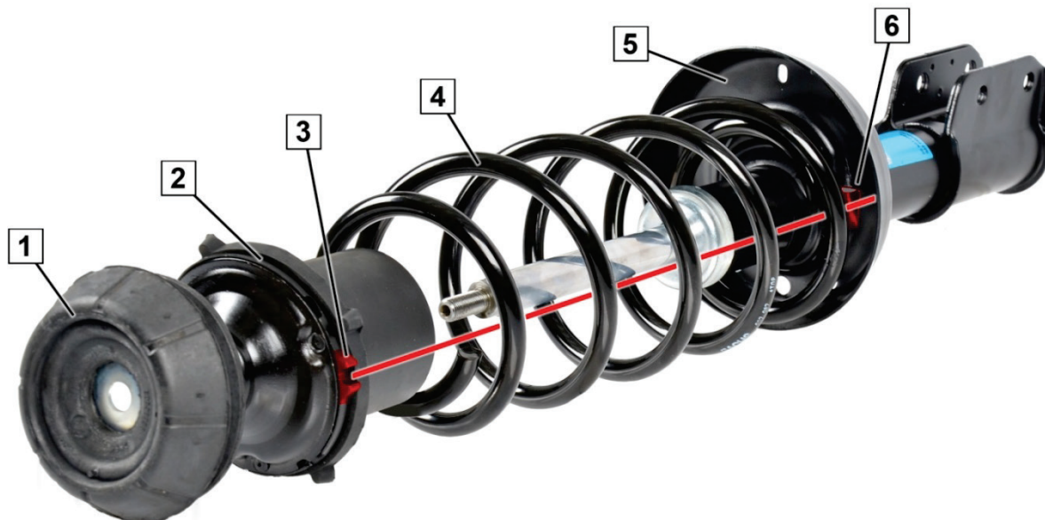
Fig. 1: Fjederbenslejet korrekt anbragt
