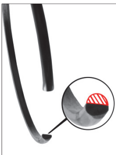
3. ábra: elkopott biztosítógyűrű, → a kinyomócsapágó leválik a membránrugóról → lökészerű erőkapcsolat
