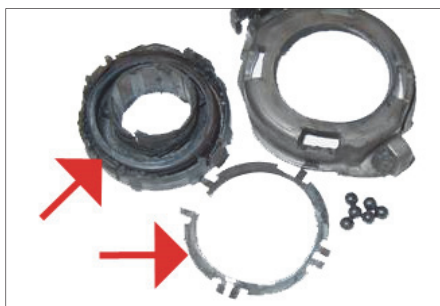
Фиг. 4: Механични повреди и прегряване на аксиалния лагер
