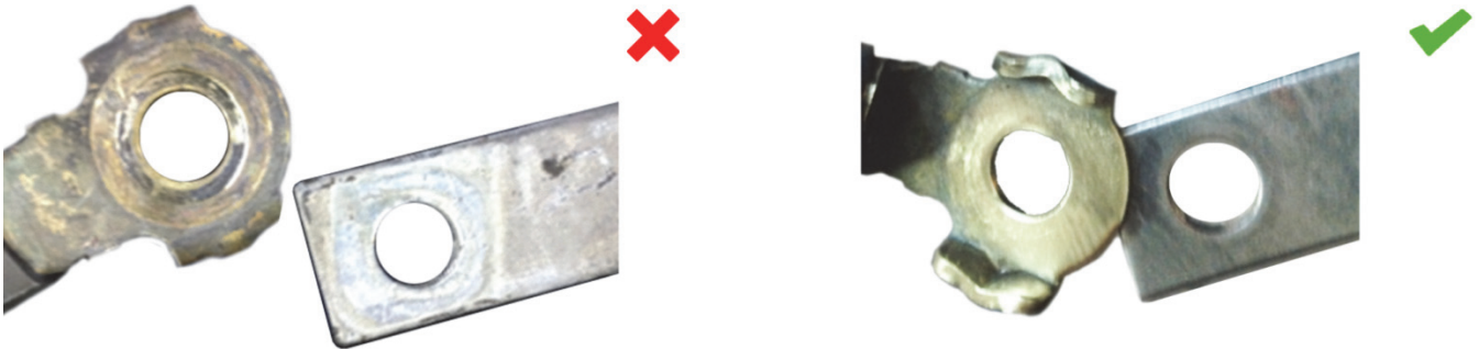
1. ábra: Illeszkedés tisztítás előtt: az érintkezés nem megfelelő 2. ábra: Illeszkedés a tisztítás után: az érintkezés megfelelő
