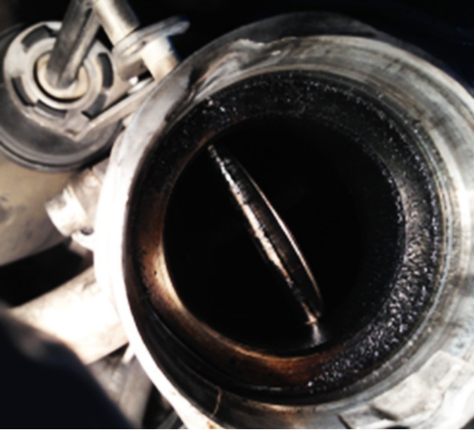
Resim 4: Egzoz Gazı Resirkülasyon valfi (EGR valfi) kurumlanmış
