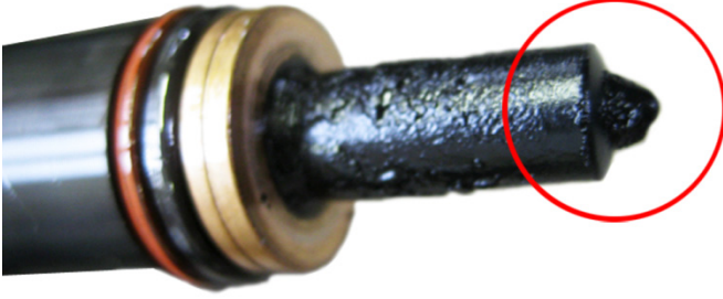
Resim 3: Enjektör memesi kurumlanmış
