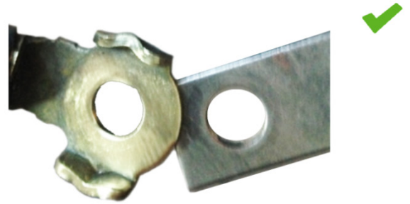
Resim 2: Temizlikten sonra topraklama bağlantısı: Kontak iyi
