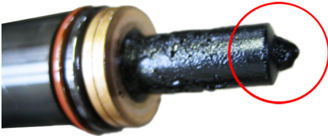
Obr. 3: Element čerpadlo-tryska je zakarbonován
