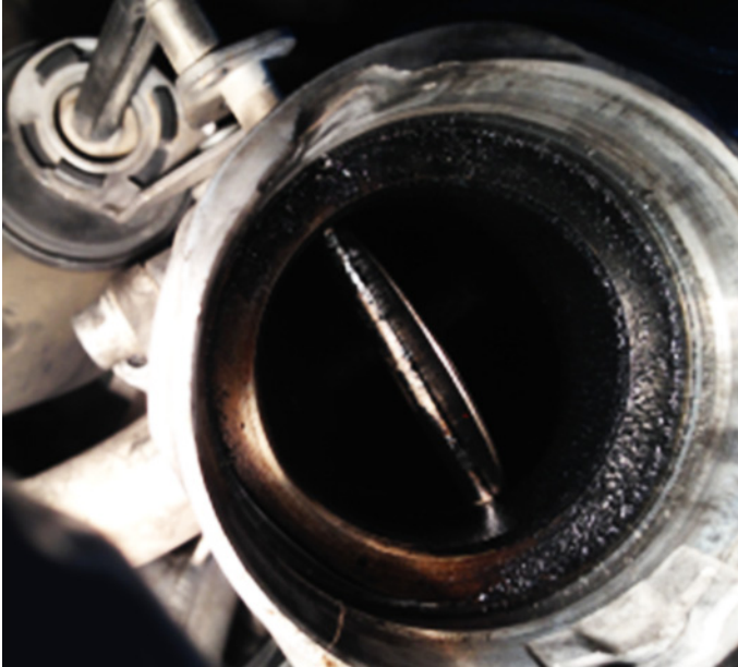
Obr. 4: Zakarbonovaná klapka ventilu recyklace spalin (ventil AGR)
