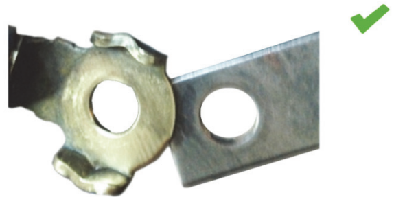
Obr. 2: Uzemnenie po očistení: kontakt dobrý
