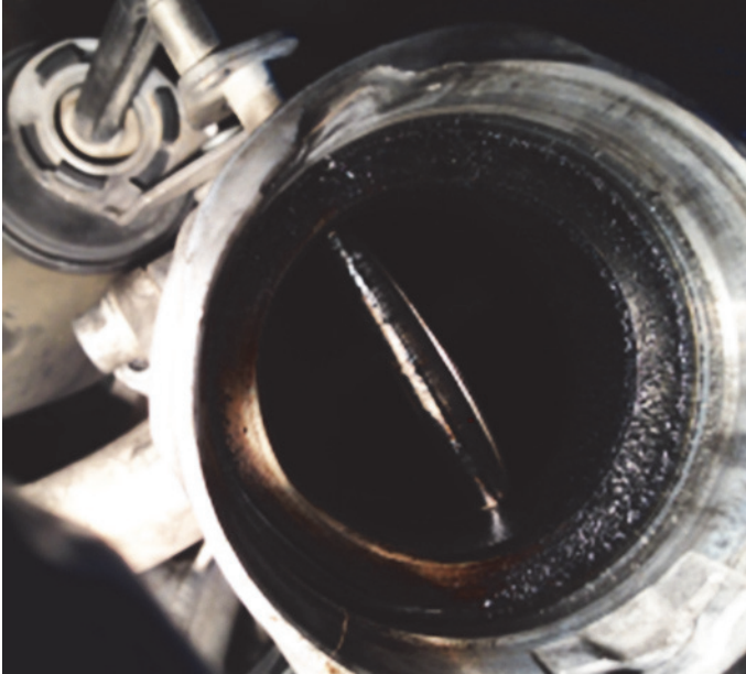
Obr. 4: Klapka ventilu recirkulácie výfukových plynov (EGR ventil) zanesená karbónom
