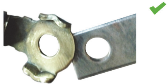
Bild 2: Jordförbindelse efter rengöringen: bra kontakt
