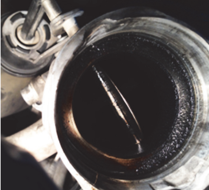
Bild 4: Ventil till avgasåterledningsventilen (EGR-ventil) förkolnad
