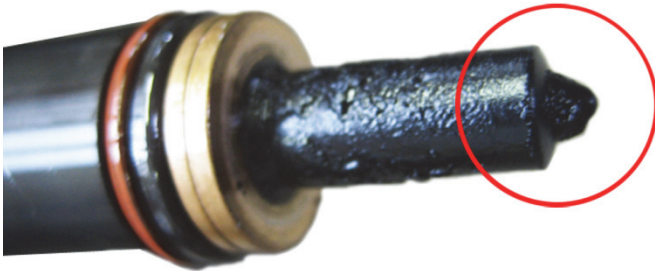
Fig. 3: Elementul duză cu pompă este acoperit cu calamină
