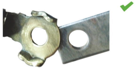
Fig. 2: Legătura la masă după curățare: Contact bun
