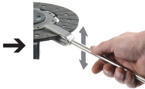
Fig. 4: Desempenar o disco da embraiagem
