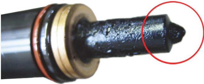
Fig. 3: Elemento da unidade de injetor carbonizado
