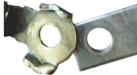
Fig. 2: Ligação da massa após a limpeza: bom contato
