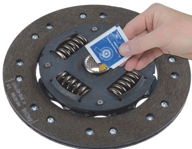
Rys. 1: Lekko nasmarować dookoła profil piasty tarczy sprzęgła
