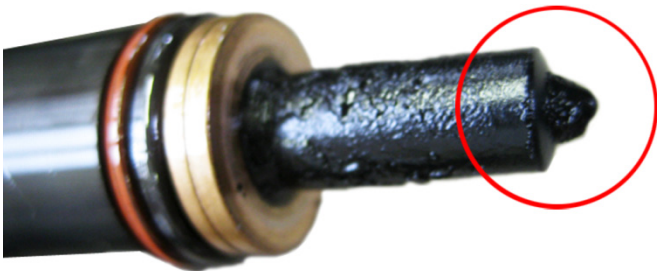
Rys. 3: Dysza pompy zanieczyszczona nagarem
