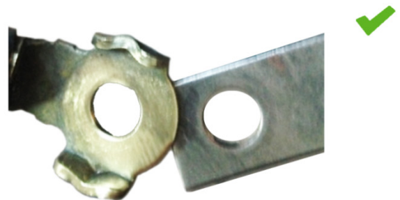
Rys. 2: Połączenie masy po wyczyszczeniu: dobry kontakt
