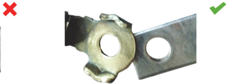
Fig. 2: Jordforbindelse etter rengjøringen: Kontakt god
