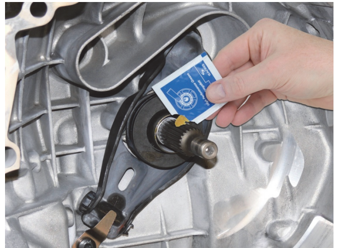
Sl. 2: lagano podmažite profil glavčine ulaznog vratila prijenosnika po cijeloj površini
