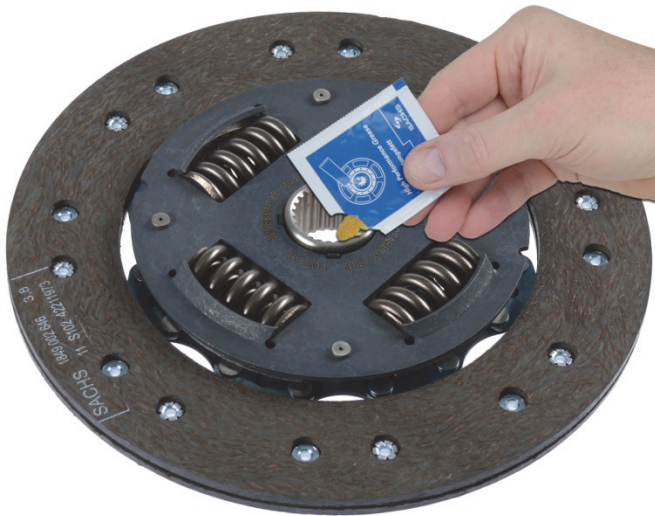
Sl. 1: lagano podmažite profil glavčine diska spojke po cijeloj površini
