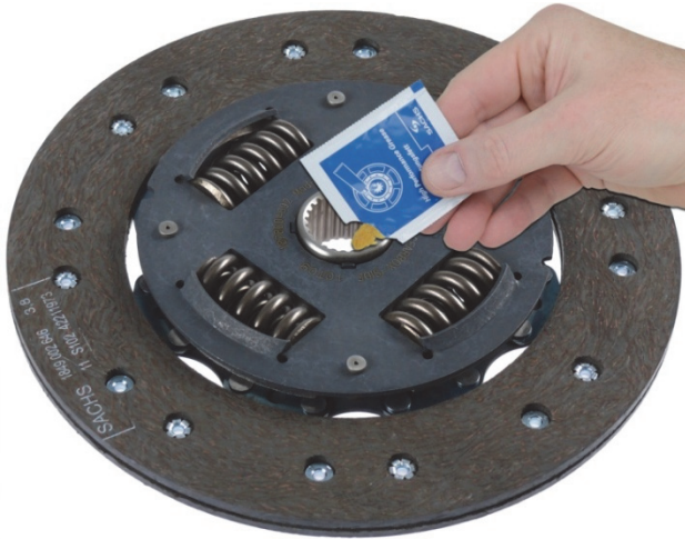
Fig.1 : Graisser légèrement le profilé de moyeu du disque d'embrayage sur tout son pourtour.
