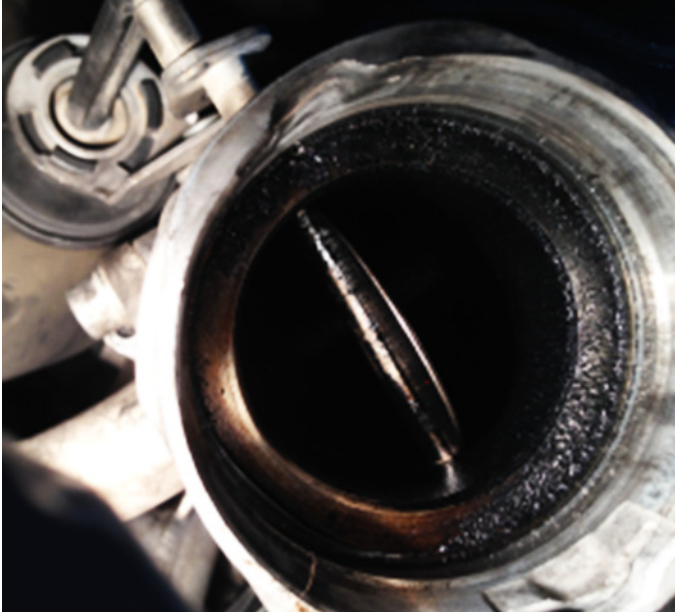
Fig. 4 : Valve de l'électrovalve de recyclage des gaz d'échappement (valve EGR) cokéfiée
