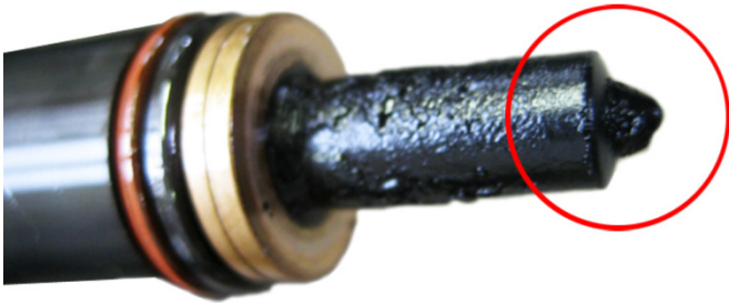
Fig. 3 : Élément de l'injecteur de pompe cokéfié
