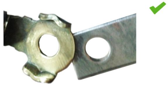
Fig. 2 : Mise à la terre après le nettoyage : bon contact
