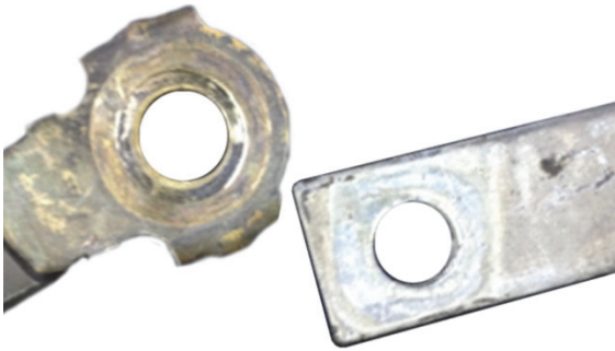
фиг. 1: Връзка към корпуса преди почистване: лош контакт
