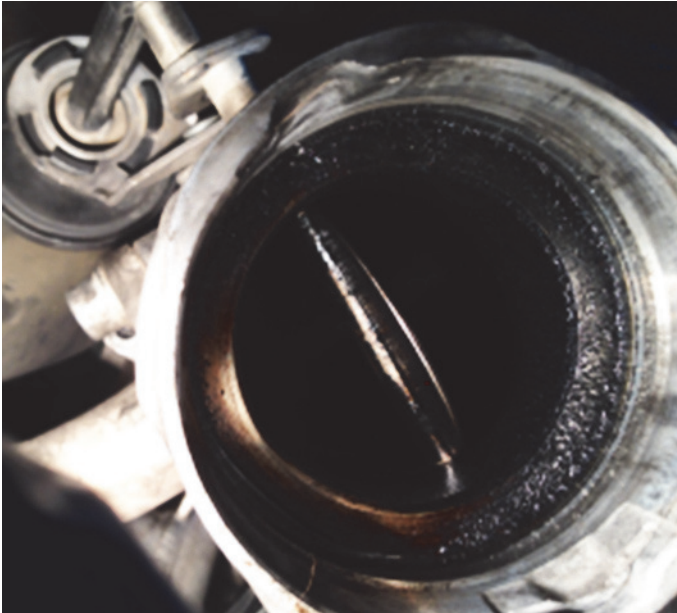
фиг. 4: Зацапана клапа на клапана за рецикулация на отработените газове (EGR-клапан)
