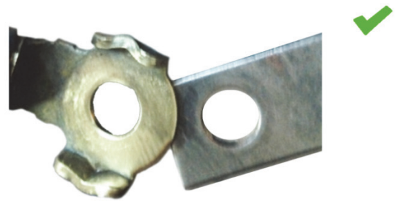
фиг. 2: Връзка към корпуса след почистване: добър контакт
