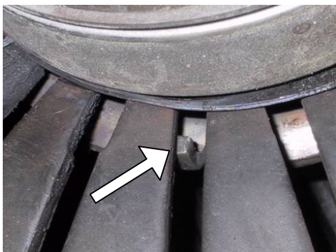
Obr.č. 1: Nesprávná pozice čepu výsuvného kroužku – čep sklouzl pod membránovou pružinu
