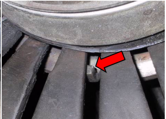
Slika 2: Napačno prileganje vodilnih nastavkov potisnega obroča – nastavek je zdrsnil pod membransko vzmet
