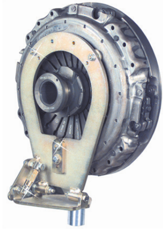
Bild 3: Monteringshjälpmedel tryckplatta Blitz Rotary art.nr. 101758
