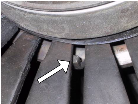
Рис. 1: Неправильная посадка направляющей цапфы разъединительного кольца – цапфа смещается под диафрагменную пружину.
