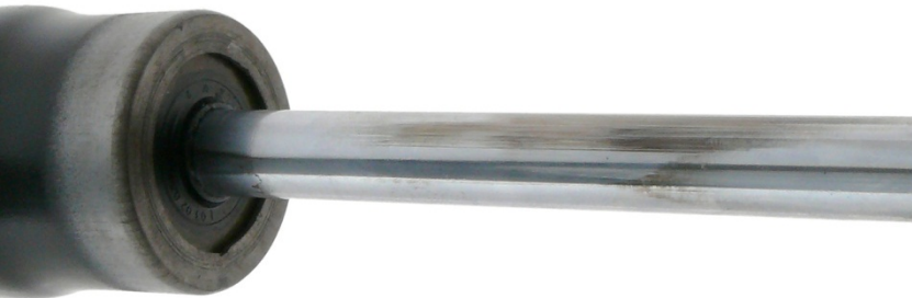
Kuva 2: Männänvarren kromipinnoite kulunut toispuoleisesti jännitykseen jääneen asennuksen takia
