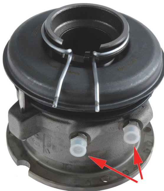
Рис. 1: концентрический рабочий цилиндр (CSC)
