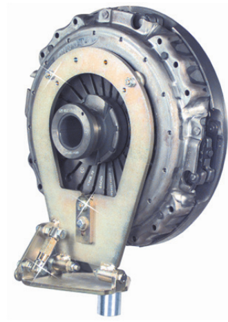
Sl. 3: Pomagalo pri montaži potisne ploče spojke Blitz Rotary br. art. 101758
