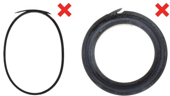
Εικ. 6: Στεγανοδακτύλιος (2) υπέστη βλάβη
