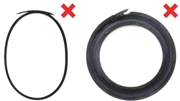
Ill. 6: Pakring (2) beskadiget
