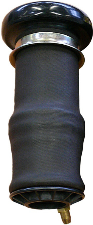
Fig. 1: Resorte neumático sustituido 27-C33-0
