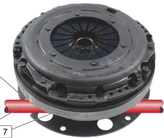
Fig. 2: Embrague, volante de inercia bimasa (7) y eje de accionamiento (6)
