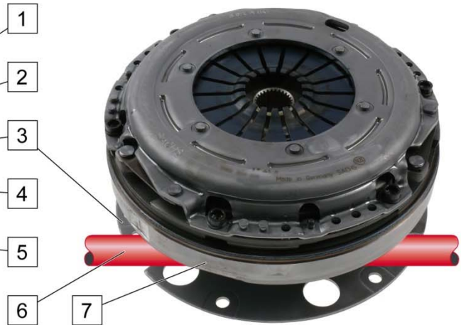
Slika 2: Sklopka, dvomasni vztrajnik (7) in pogonska gred (6)
