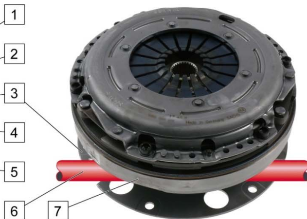
Obr. 2: Spojka, dvojitý zotrvačník (7) a hnací hriadeľ (6)
