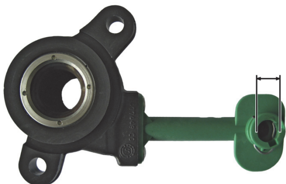
SI. 1: CSC 3182 600 121 → 3182 654 165 prečnik hidrauličkog priključka 11,7 mm
