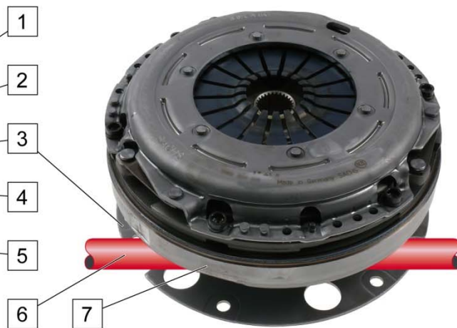
Sl. 2: Spojnica, zamajac sa dve mase (7) i pogonsko vratilo (6)
