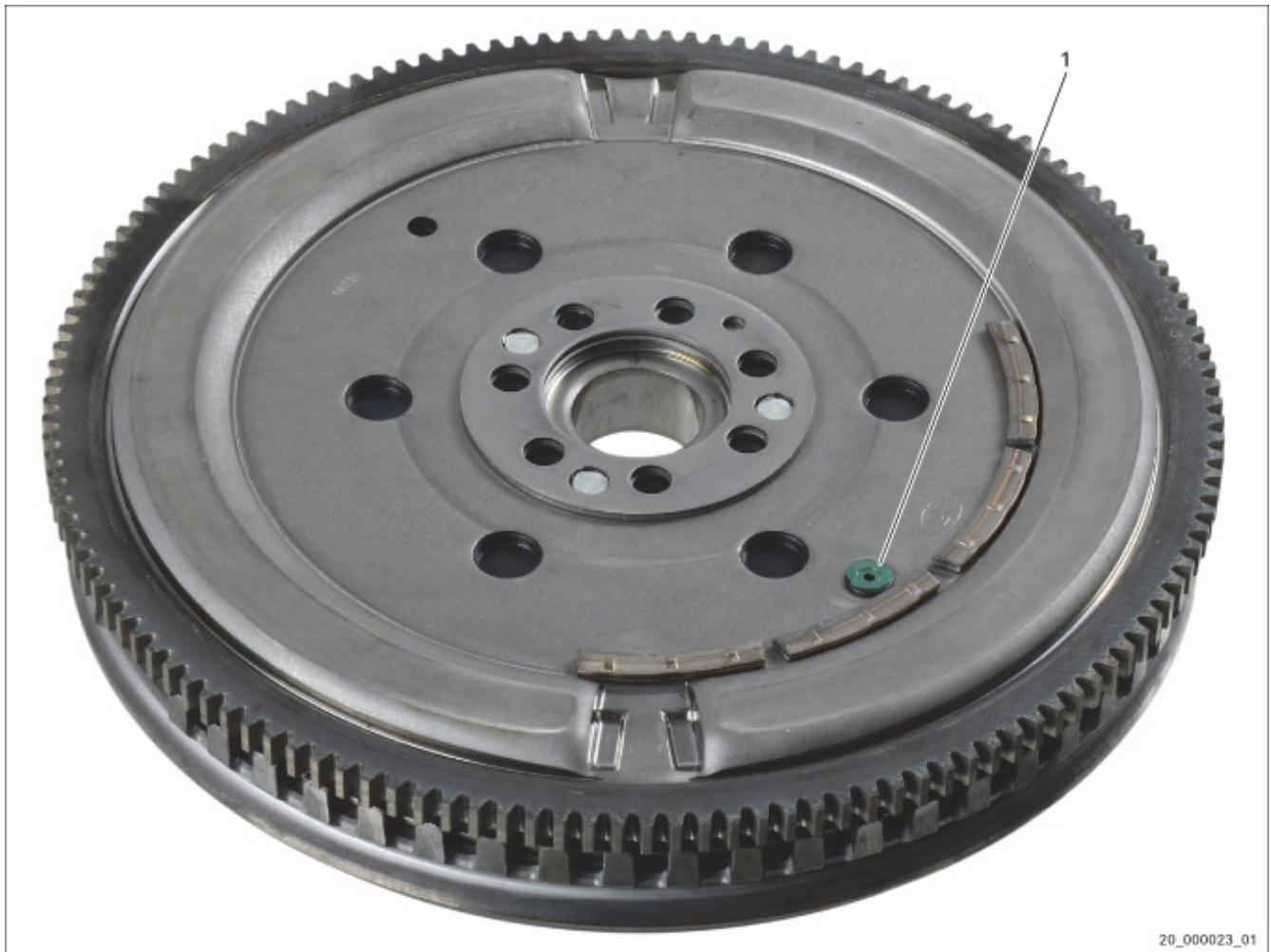
Рис. 1: двухмассовый маховик с защитой при транспортировке
