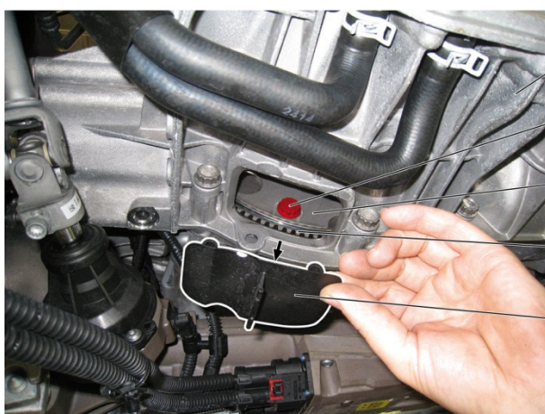
Рис.1 Защитная крышка (5) снята
