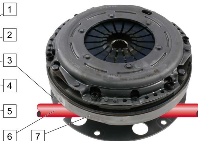
Fig. 2: Ambreiaj, volantă cu masă dublă (7) și planetară (6)
