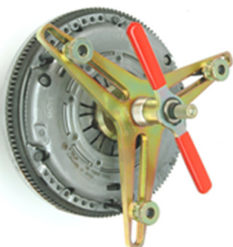
Fig. 3: Dispositivo de aperto com mandril de centragem
