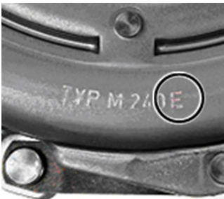
Rys. 2: Wszystkie sprzęgła Xtend mają dodatkową literę oznaczenia – E. Przykład: M 240 E
