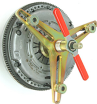
Rys. 3: Przyrząd mocujący z trzpieniem centrującym
