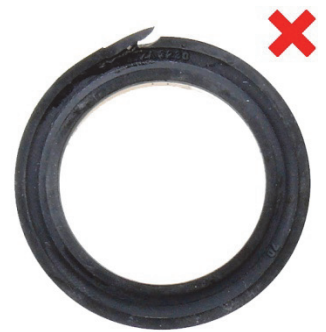
Illustr. 7: Lipafdichtring (1) afgeschoven
